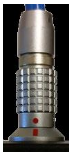
Рисунок 3. Разъем Lemo для блока GK-404.
