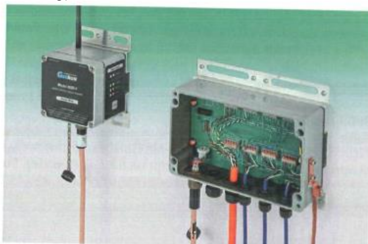
Рисунок 13 - Датчик с мультиплексором
